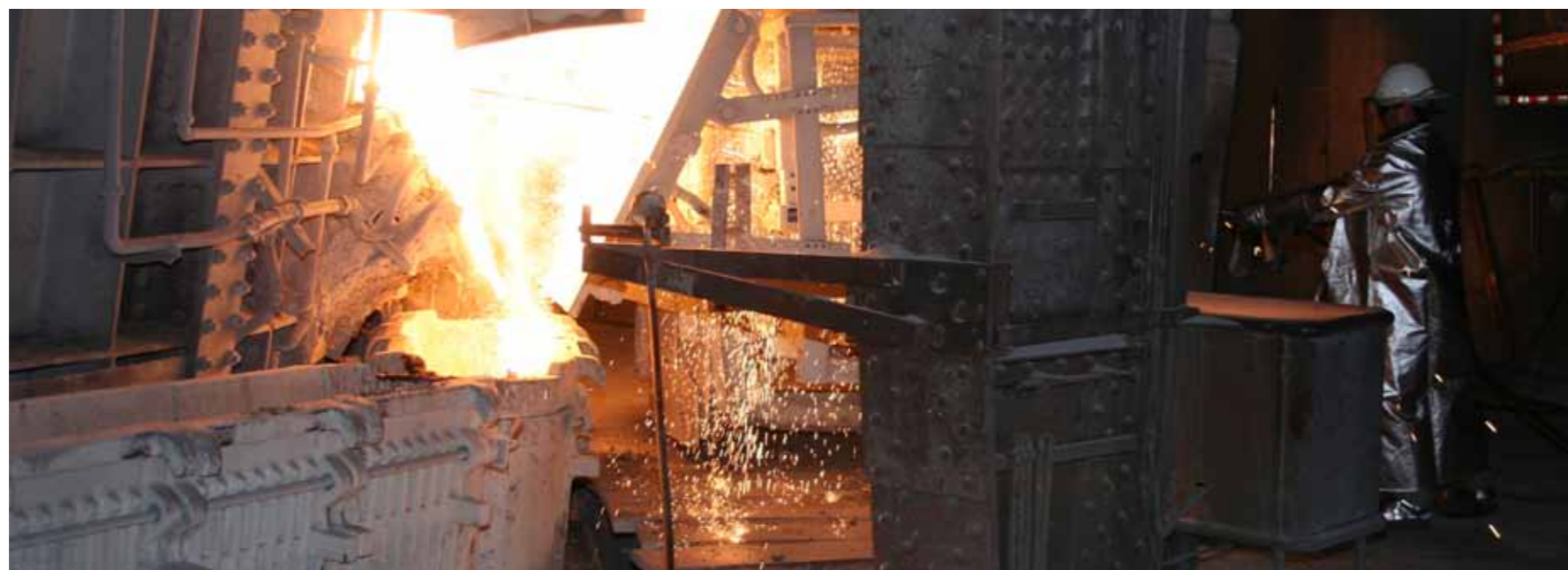
Hier sieht man den sogenannten Abstich. Das schmelzflüssige Calciumcarbid fließt aus dem Reaktor in Carbidpfannen.
